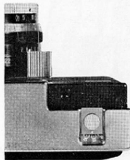
Appuyer sur le bouton strié 1. Le faire tourner dans le sens inverse des aiguilles d'une montre, pour amener le compteur sur le repère orange placé entre les graduations 36 et 0 (pour un film de 36 poses) ou sur la graduation 22 (pour un film de 20 poses).
