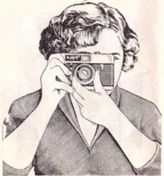
Наводка на резкость осуществляется вращением оправы объектива, перемещение которой кинематически связано с работой видоискателя дальномера.
